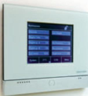
**In ogni ambiente un touchscreen permette di controllare, in base ai permessi di amministratori e utenti, le funzioni dei sistemi e riporta, in caso di necessità, le opportune segnalazioni di allarme (presenza fumo, gas, allagamento)**
