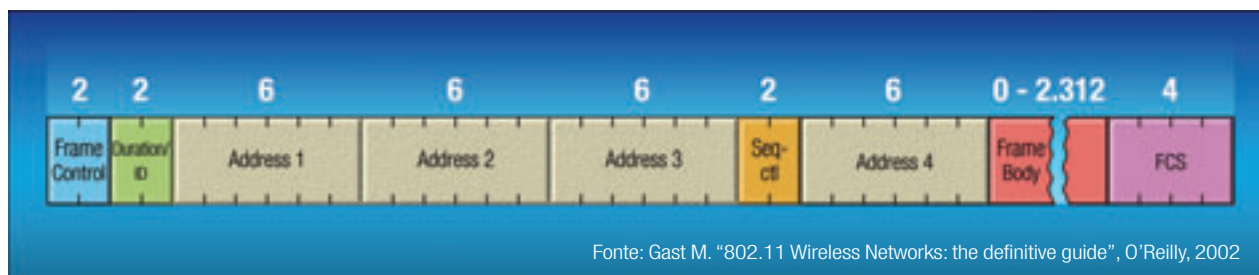
Figura 3 - La struttura di un frame 802.11
