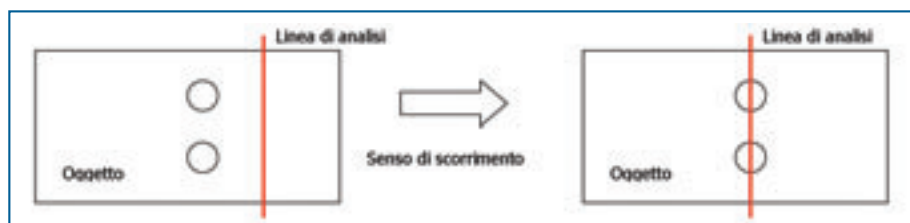
Figura 1 - Principio di funzionamento della ricostruzione lineare
