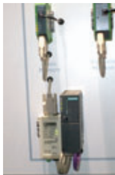
Il modulo convertitore da RS-232 a MPI per collegare PLC Siemens ai modem Phoenix Contact
