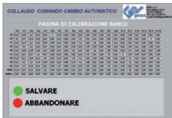
**Al termine del 'wizard', il sistema calcola medie e deviazioni standard indicando la presenza di accavallamenti tra i rilevamenti delle diverse posizioni della leva del comando**
