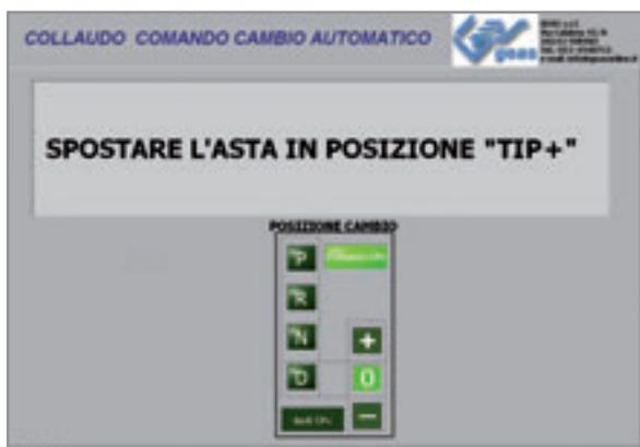
**Nella sequenza di test, il sistema riconosce automaticamente il raggiungimento della posizione richiesta e invia un messaggio all'operatore indicando lo step successivo da eseguire**
