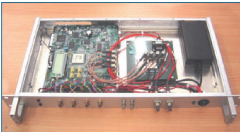
**Dimostratore di un codec SpaceFibre**
