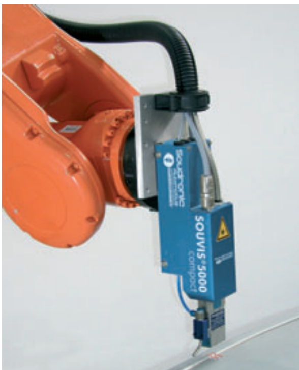
Testa del sistema di controllo qualità di Soutec con telecamera Cmos di Photonfocus
