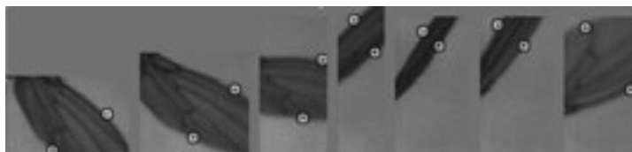
TrackCam di Photonfocus legge ROI di dimensioni differenti dall'immagine completa
