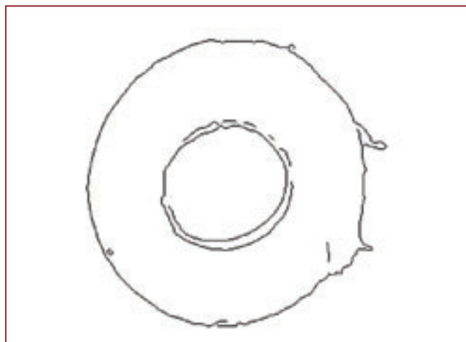
Figure 5 - I bordi del rotolo precedentemente mosato nella figura 1 ottenuti tramite l'algoritmo di individuazione contorni
