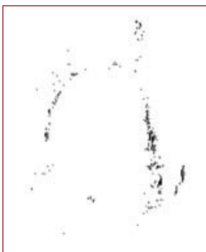
Figura 6 - Il risultato finale della fase di image processing: l'immagine ottenuta contiene i difetti presenti sulla superficie di taglio del rotolo
