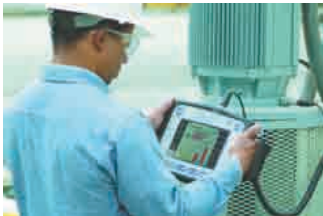
Monitoraggio di vibrazioni con CSI 2130
