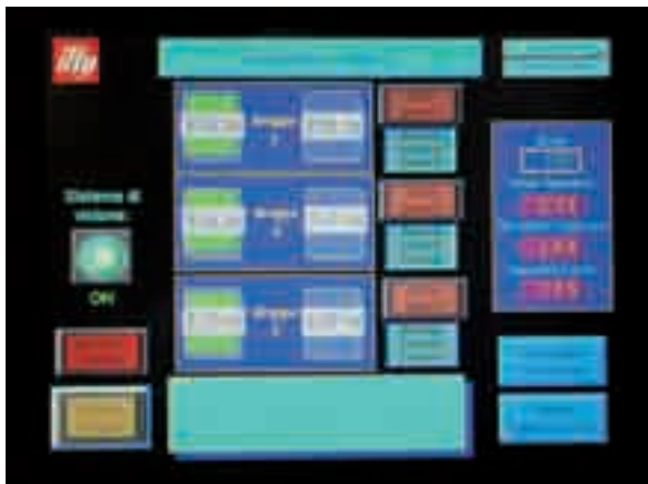
L'interfaccia uomo-macchina è affidata a un touch-screen NS10 di Omron, dal quale l'operatore può monitorare lo status di ogni singolo barattolo testato, prima del confezionamento
