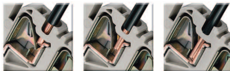
Figura 1 - Anatomia del sistema di connessione Push In: il conduttore, inserito senza utensili nella sede, viene tenuto in posizione da una molla in acciaio inossidabile che lo preme contro la barra in rame del contatto
