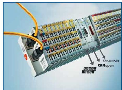
Una stazione I/O è costituita da un accoppiatore Ethercat e da un numero pressoché infinito di terminali.
