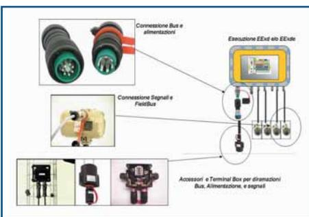
anche in versioni dedicate per l'uso con cava armato. La linea eXLink comprende anche i terminal Box Y-Link, nati per agevolare le diramazioni di linea, sia seriale che di alimentazione. Gli eXLink sono già stati utilizzati con successo per
