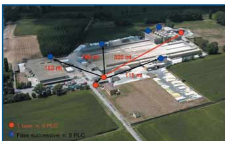
Con l'aiuto di Siemens e del software Sinema E, F.M. Automazione ha effettuato uno studio di fattibilità per verificare la copertura radio data dai dispositivi
