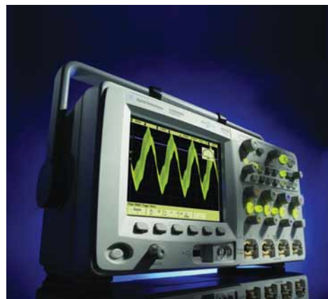
Il DSO5054A: 500 MHz e 4 canali
