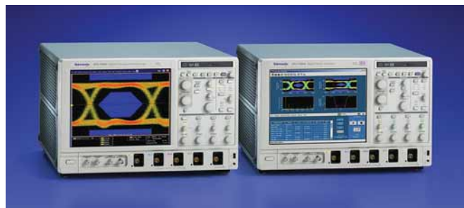
DPO70804 e DSA70804 Tektronix sono i modelli a 8 GHz della famiglia DPO/DSA70000 di cui fanno parte anche i modelli DPO70604 e DSA70604
