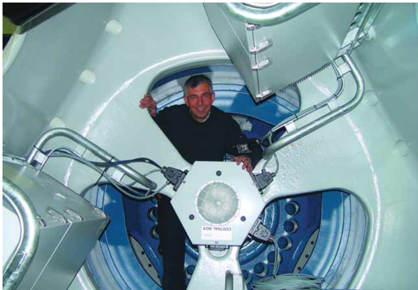
Interno del mozzo con sistema 'pitch'
