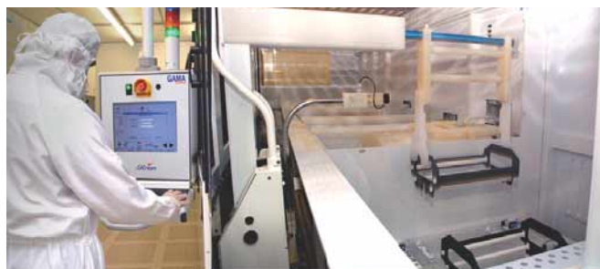
Cappa automatica per l'attacco umido del silicio nella linea Mems di Agrate
