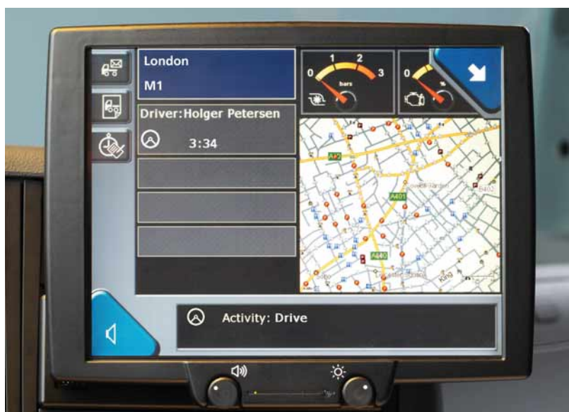
I moderni terminali di gestione flotte montati sui veicoli sono integrati anche con gli altri sistemi elettronici del mezzo di trasporto, come in questo modello Integrator 500 di Scania
