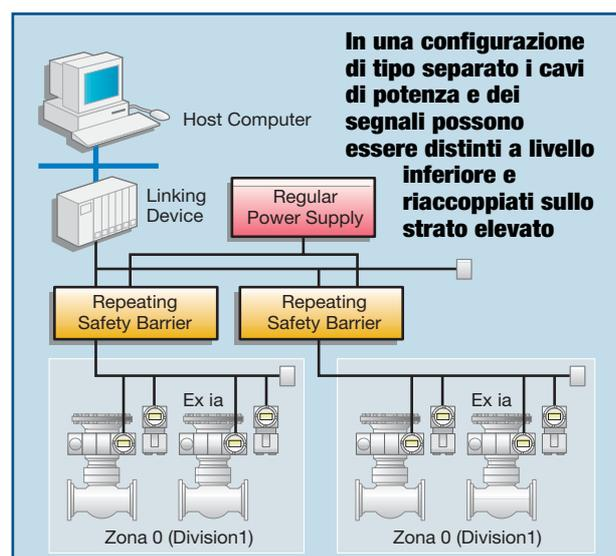
**Il power trunk rende i sistemi intrinsecamente sicuri senza limitare la potenza sui bus**
