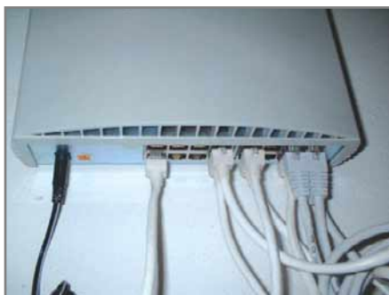
L'hub è un nodo smistatore, i dati in ingresso all'hub da una qualsiasi porta sono inoltrati a tutte le altre porte del dispositivo
