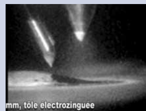
Interruzione del contatto ed estremità del filo appuntita quando la velocità decresce a zero
