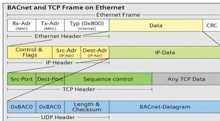
**Esempio di mappatura del protocollo BACnet quando viene utilizzata Ethernet come rete di comunicazione. Con la definizione dello standard BACnet/IP è stato inoltre definito come trasportare i protocolli BACnet all'interno di reti geografiche IP potenzialmente estese a tutto il mondo**
