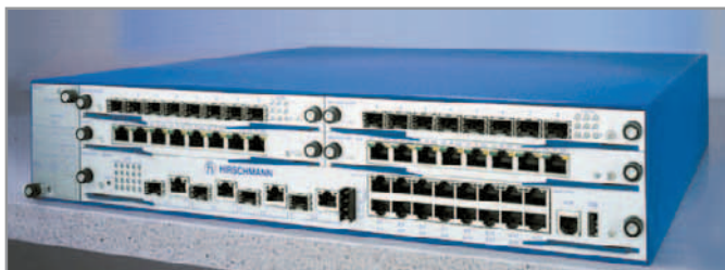
Lo switch Gigabit-Ethernet Mach 4000 è un sistema ad alta densità di porte per montaggio in rack 19"
