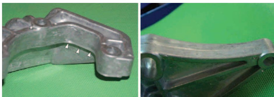
Figura 13 - Alcuni particolari delle superfici lavorate
