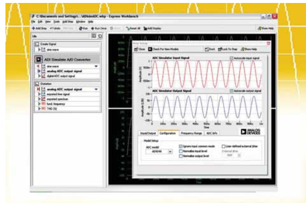
Una schermata del software ADIsimADC e SignalExpress, per l'analisi dei convertitori analogico digitali
