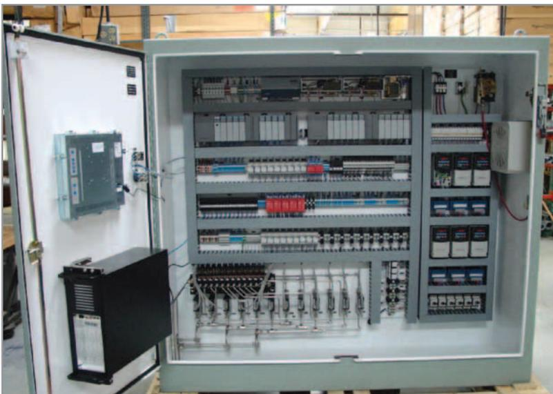
**Sistema di controllo di un processo industriale di polverizzazione (Fonte: Lakota Engineered Systems)**
