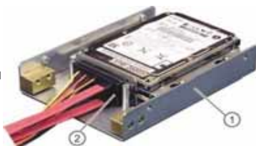
Fig. 3 - Modulo integrato con doppio hard disk su supporto antivibrante, per il 'mirroring' sicuro dei dati
