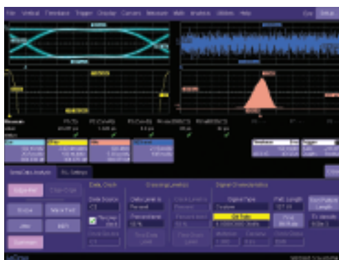
Sda 11000 permette di effettuare test su segnali con bit rate a 6 Gb/s
