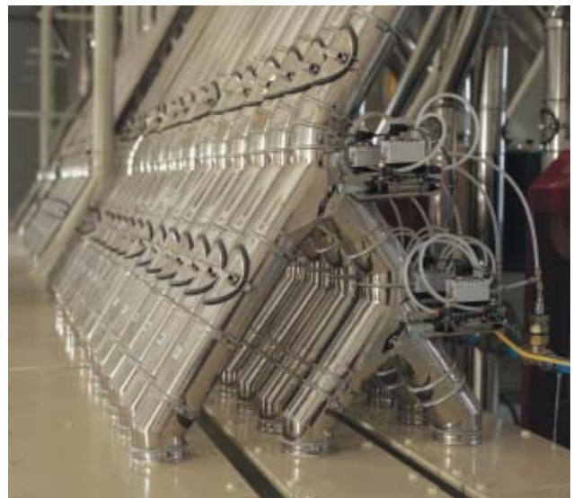
Figura 4 - Serie di valvole deviatrici in rete Asi
