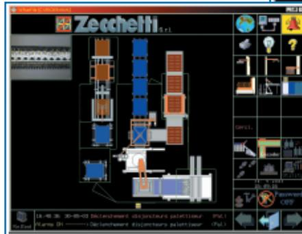
**Grazie all'applicativo di supervisione installato su ogni PC viene controllata ogni parte dell'impianto; come Scada è stato utilizzato Super-Flash di Automa**
