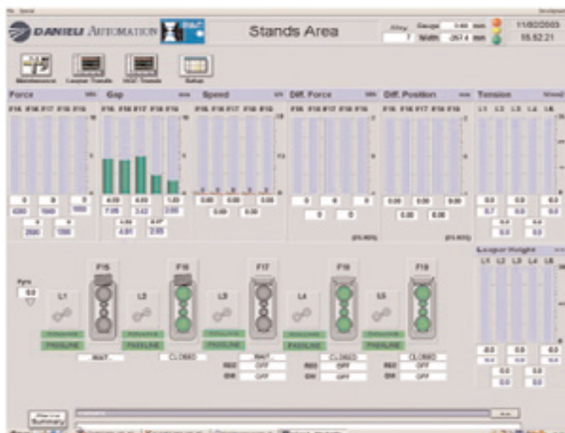
Figura 8 - Interfaccia Uomo-Macchina (Hmi) per l'impianto di laminazione a caldo
