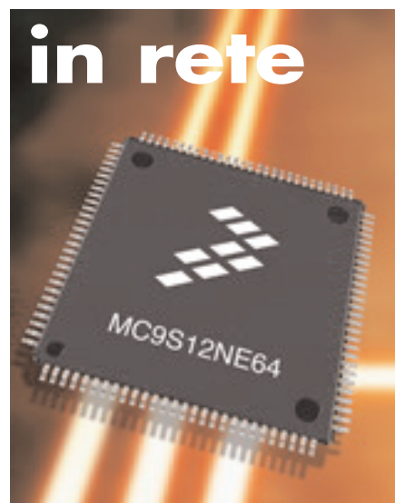
Il microcontrollore di Freescale con Ethernet integrata
