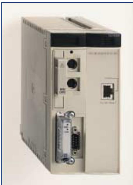
**Il PLC Premium permette, in caso di architettura distribuita, di installare da uno a sedici rack, collegati fra di loro mediante il bus dati X Open**
