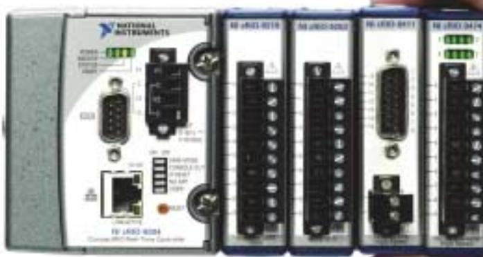
Il sistema embedded riconfigurabile CompactRIO di National Instruments
