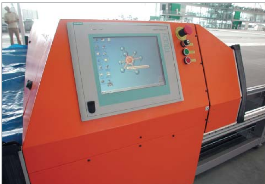
Esempio di postazione HMI a bordo macchina per il controllo, la diagnostica e la manutenzione
