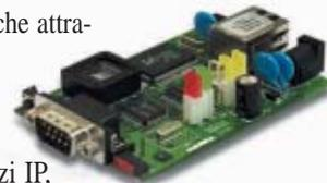
La connessione seriale avviene tramite un connettore DB9 maschio e supporta i segnali Rx, Tx, RTS, CTS, DTR, DSR con controllo di flusso hardware RTS/CTS o Xon/Xoff e velocità massima pari a 115 kbps. Il collegamento alla rete LAN 10Base-T avviene mediante un connettore RJ45 con IP statico o dinamico. L'accesso mediante ID e password garantisce un buon margine di sicurezza. E' disponibile in versione boxata (LS100), OEM (LS100B), o solo modulo (LS100M).
