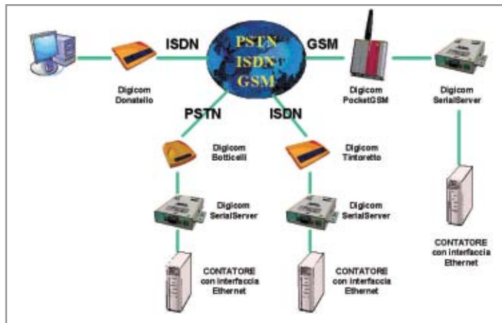
Fig. 4 - Tipi di connessione proposti da Digicom tra il centro di raccolta dati e i dispositivi sul campo per effettuare il telecontrollo puntuale
