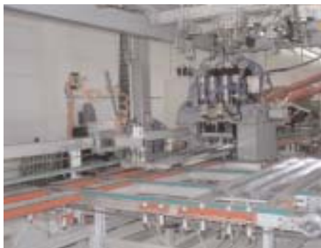
Macchine per clinching su pedane per edilizia
