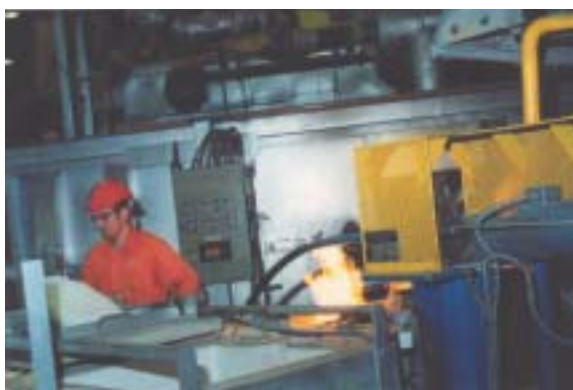
Anche se montati a ridosso dei forni, i PanelView Allen-Bradley funzionano senza problemi
