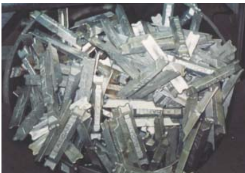
Una cesta contenente sette tonnellate di alluminio pronta per essere versata nel forno di fusione
