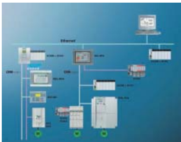
La nuova CPU XControl-XC200 è dotata di interfacce Ethernet e CANopen integrate
