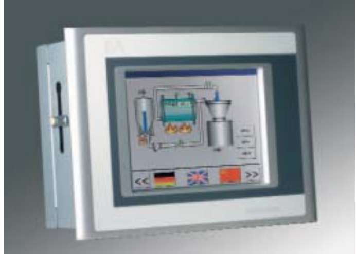
Fig. 7 - I Power Panel sono di fatto dei dispositivi potenti che integrano in una unica CPU la parte di visualizzazione e controllo della macchina
