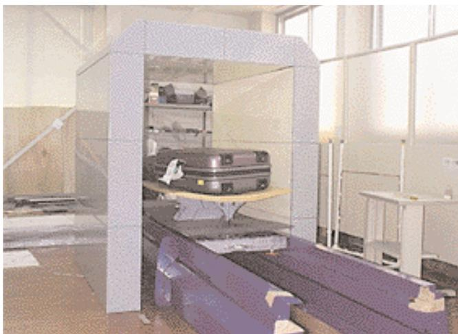
**Figura 7** - Sistema automatico per lo smistamento bagagli basato su una tecnologia che fa uso di smart label (fonte Omron Electronics)
