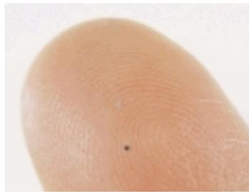
**Figura 10** - Il meu-chip è un sistema Rfid con chip dalle dimensioni estremamente contenute (~0,4 mm<sup>2</sup>)
