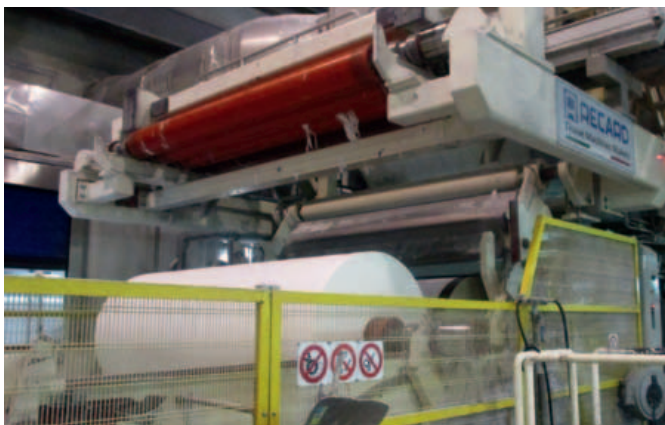
Specialità delle cartiere di Lucca è la carta 'tissue' a grammatura bassa per usi igienici, sanitari e domestici
