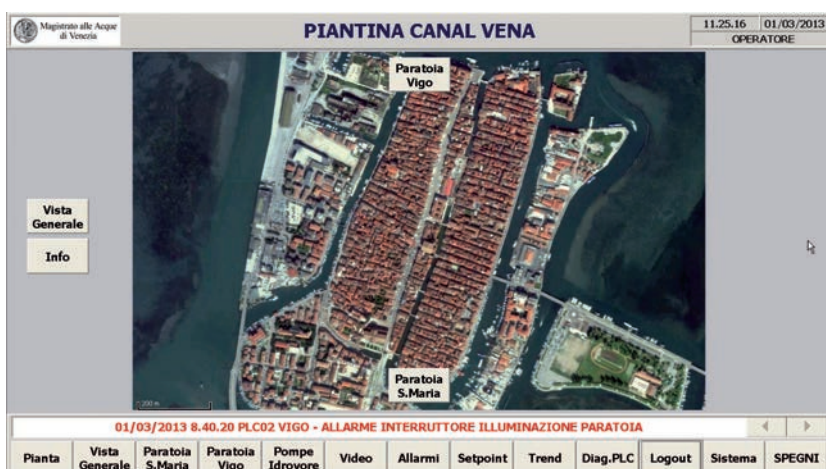
Il supervisore Movicon del sistema Baby Mose mostra la pianta Canal Vena dove sono state installate paratoie: paratoia di Vigo e di Santa Maria
