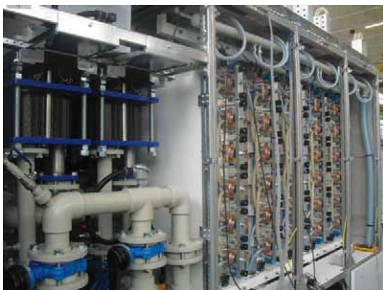
Le macchine di Friem sono raffreddate da acqua deionizzata e acqua industriale che circolano all'interno di uno scambiatore industriale di calore
