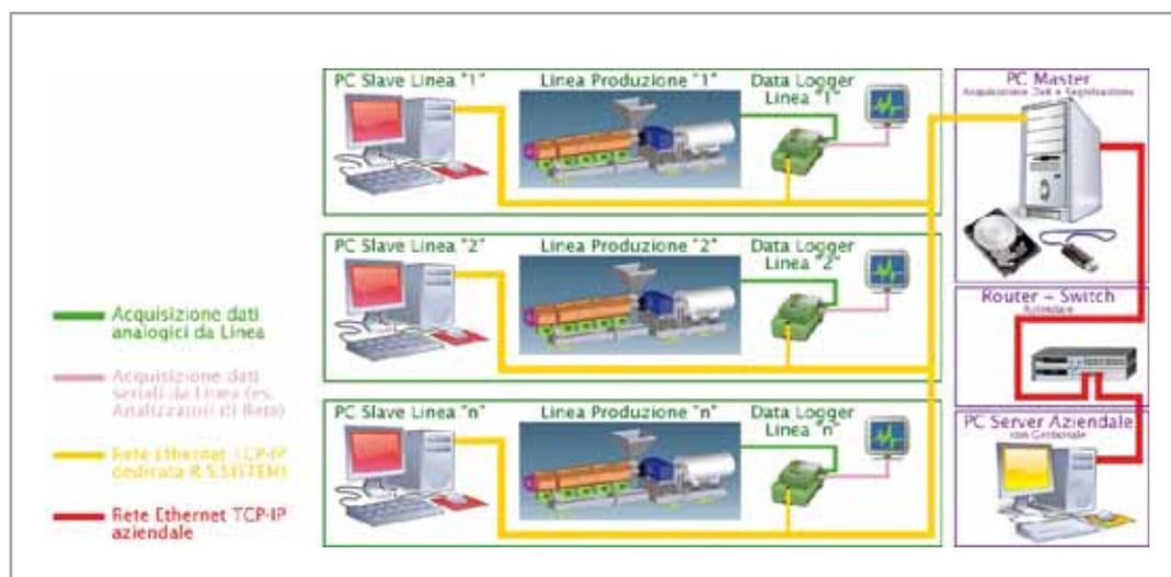
**RS Measure Energy permette di verificare l'effettivo consumo energetico di una o più linee di lavorazione e registrarne i dati**
