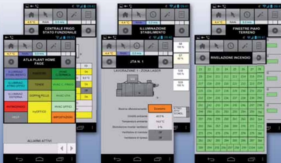
Il supervisore prevede pagine grafiche specificamente progettate per i sistemi mobili
