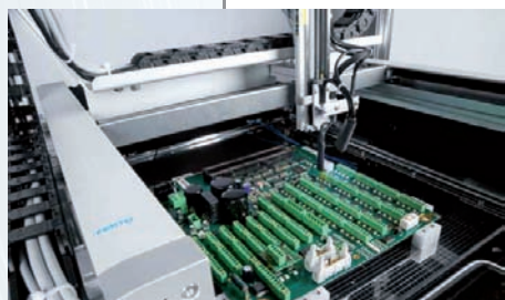
Collaudo meno costoso per i circuiti stampati: il Flying Probe Testsystem di Visatronic dotato del mini portale H Excm
