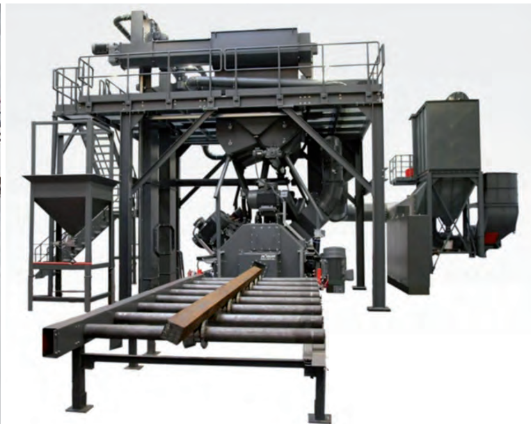
Una linea di conservazione e un impianto di granigliatura RKL.
