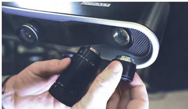
Il sistema Cobalt è configurabile dall'utente con più campi visivi. Kit di ottiche intercambiabili permettono di acquisire dati a nuvola di punti per pezzi di varie dimensioni.
