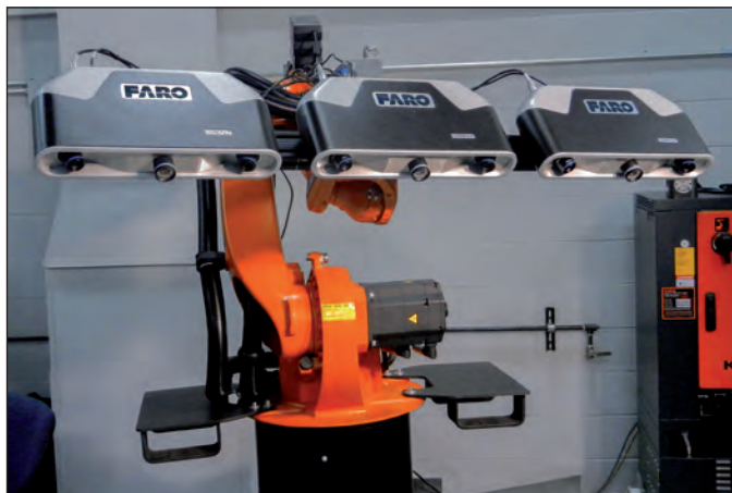
Il sistema Cobalt è configurabile dall'utente con più campi visivi. Kit di ottiche intercambiabili permettono di acquisire dati a nuvola di punti per pezzi di varie dimensioni.
