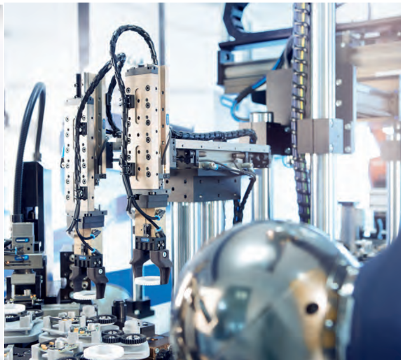
Il robot impugna una ruota in alluminio e la porta nella posizione corretta durante l'ispezione a raggi X. Una fase di una produzione intelligente.
