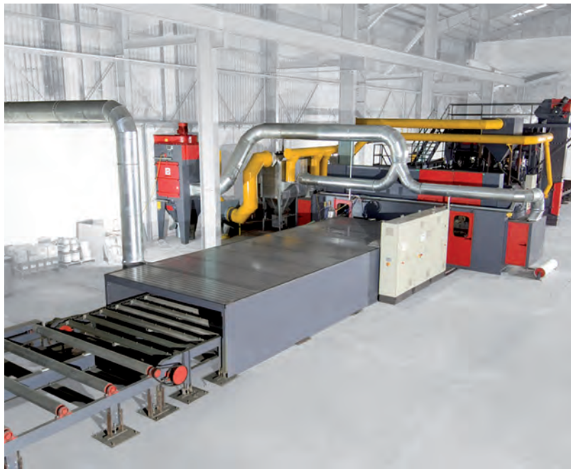
Una linea di conservazione e un impianto di granigliatura RKL.
