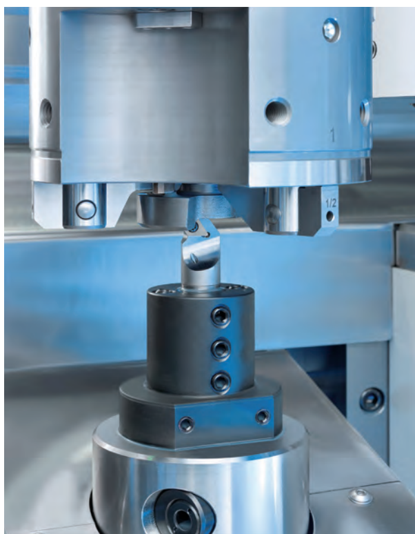
A sinistra, tornitura del temprato sulla VLC 100 GT; a destra, rettificazione interna del foro.
